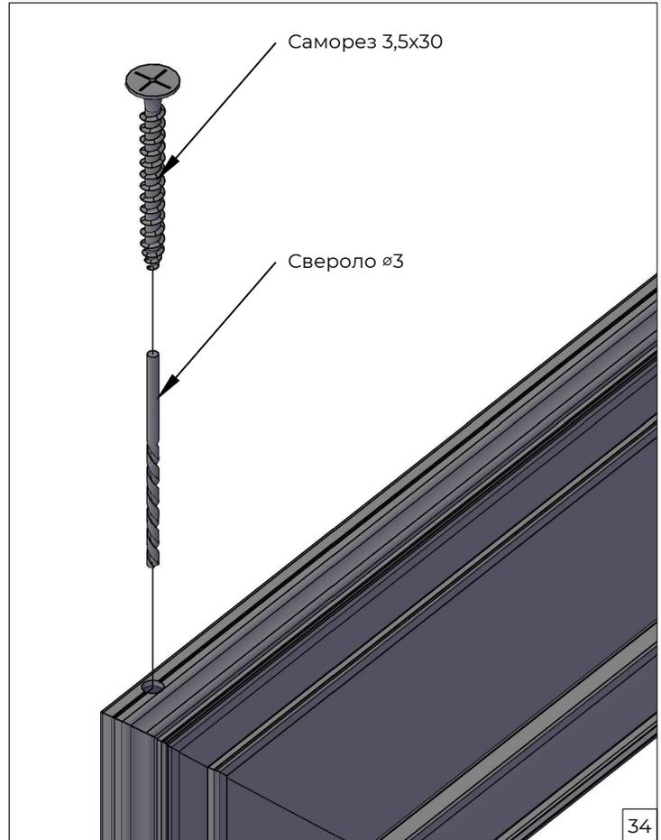
Зафиксируйте обратный наличник при помощи саморезов
