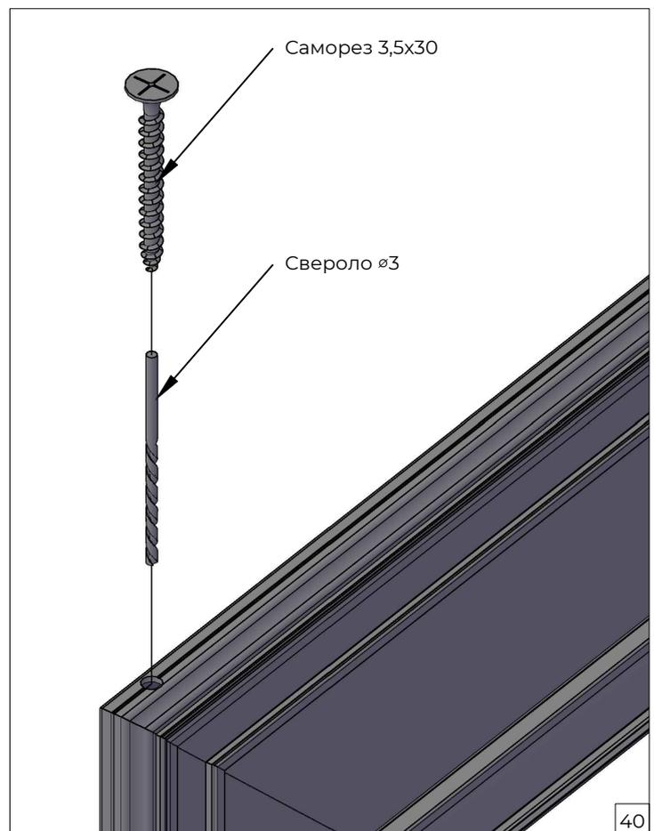
Зафиксируйте обратный наличник при помощи саморезов
