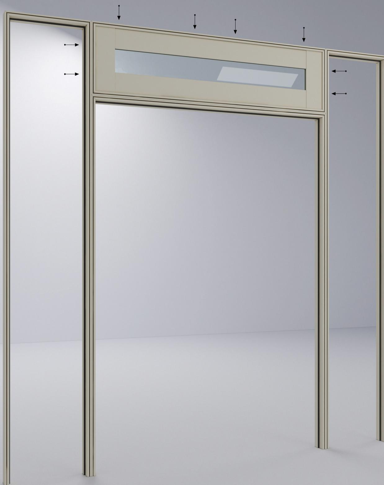
Далее, прикрутите притворную планку к нижнему торцу стационарных полотен. Полотна крепим с внешних сторон и в местах установки петель.
