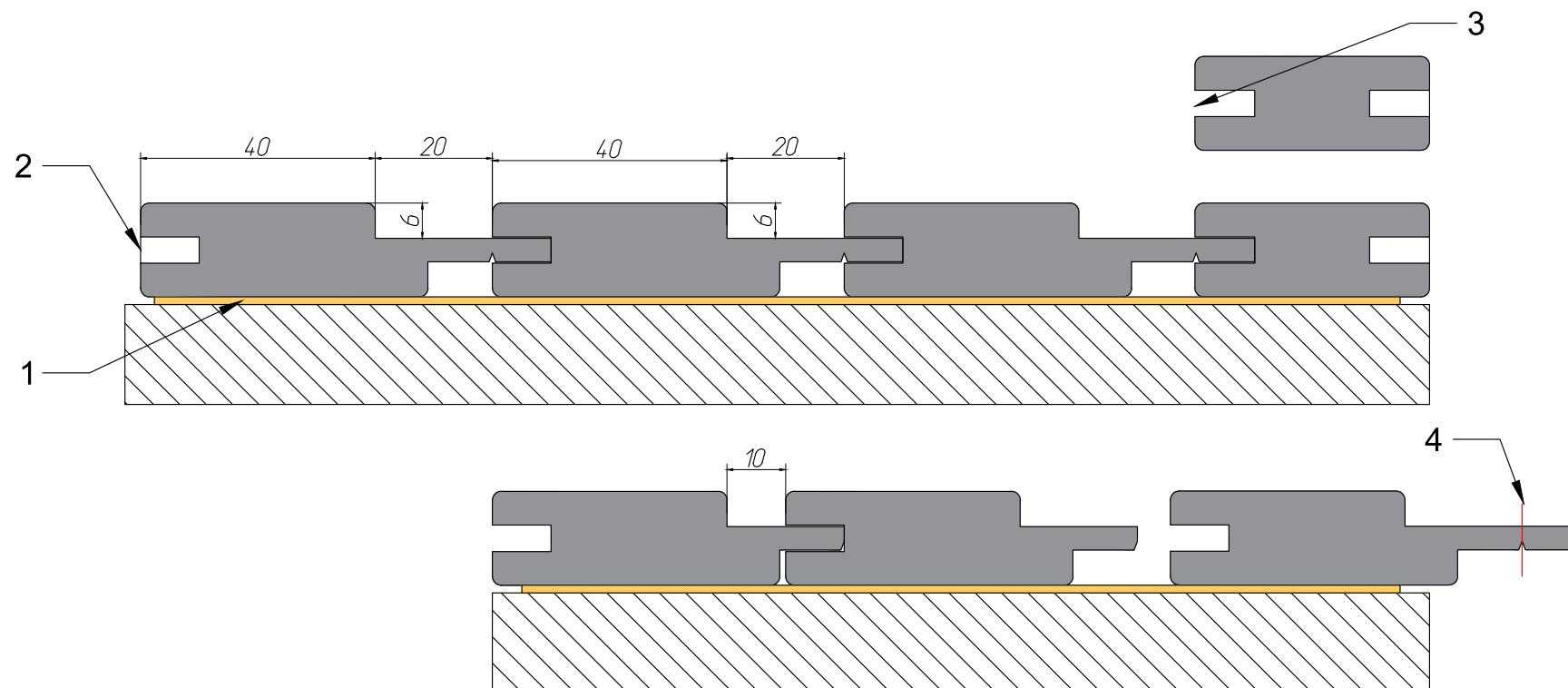
1. Стеновые панели монтируются на клей (жидкие гвозди).
