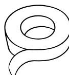
15. Двухсторонний скотч (шириной 20-30 мм), из расчета 15 метров на одну панель размером 1200x3000 мм
